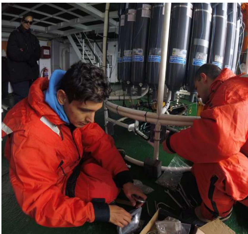
**Foto acima:** Brendon ajustando o aparelho CTD (*Conductivity, Temperature, Depth*) na roseta para, então, ser lançado ao mar para coletar dados físico-químicos durante a perna de fevereiro 2020 da Operação Antártica.
